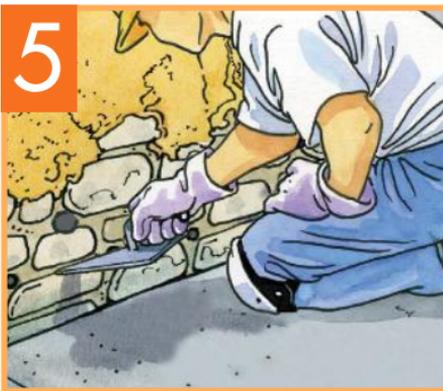
Dopo l'iniezione di **TRIPLEZERO** stuccare i fori con malta rapida **SPIDY 15**.
